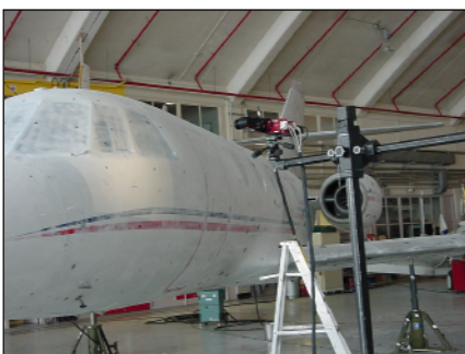
Digitalisation de l'avion en utilisant le système de mesure Atos II, monté sur trépied ou nacelle articulée. A droite, différents patches de mesure sont recalés automatiquement par rapport au squelette de référence défini dans Tritop.
