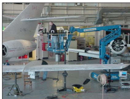
Digitalisation de l'avion en utilisant le système de mesure Atos II, monté sur trépied ou nacelle articulée. A droite, différents patches de mesure sont recalés automatiquement par rapport au squelette de référence défini dans Tritop.
