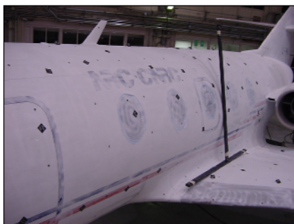
Pose des vignettes sur l'avion. A droite, les vignettes automatiquement identifiées sont visualisées dans le système de Tritop. Ces vignettes représentent le squelette de référence pour le recalage des différents patches de mesure.
