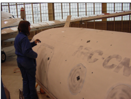
Pose des vignettes sur l'avion. A droite, les vignettes automatiquement identifiées sont visualisées dans le système de Tritop. Ces vignettes représentent le squelette de référence pour le recalage des différents patches de mesure.
