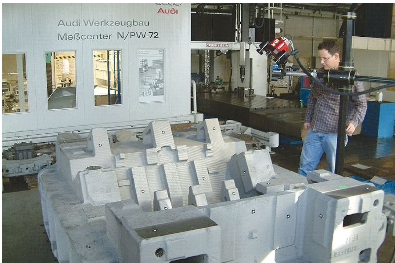
Fig. 10: Relevé rapide avec ATOS, configuré en grande surface de mesure, d'un brut de fonderie
