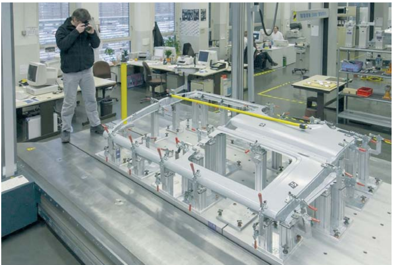
Fig. 4: Mesure d'un côté de caisse avec TRITOP
