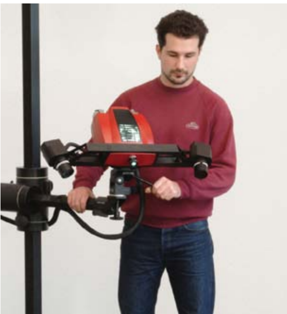
Fig. 2: Mise en situation du capteur ATOS
