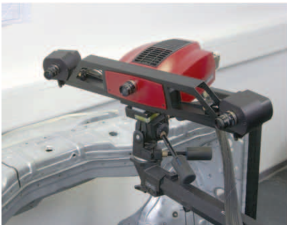
Fig. 3 ATOS, le capteur 3D, conçu pour les mesures en laboratoires de métrologie et les environnements industriels
