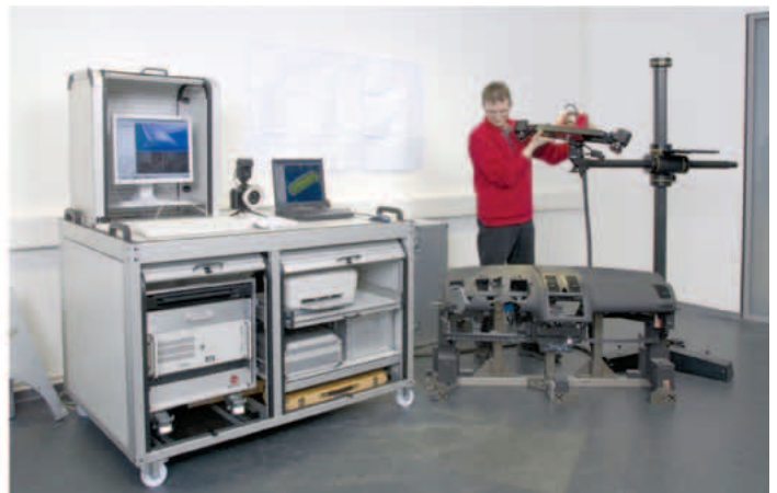
Fig. 3 ATOS, le capteur 3D, conçu pour les mesures en laboratoires de métrologie et les environnements industriels
